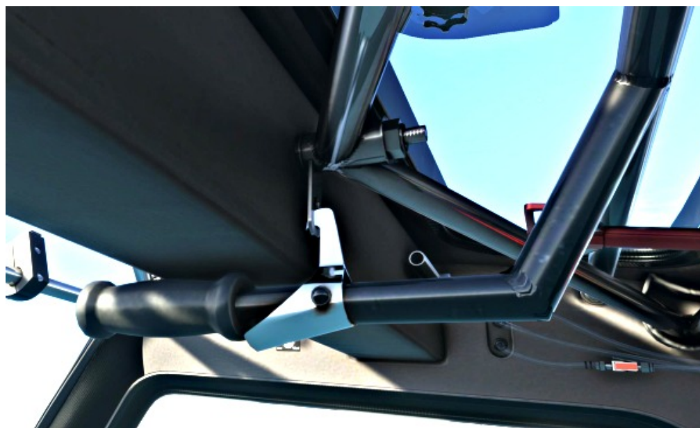
Bediening van de flaps met en grote hendel met directe overbrenging.
